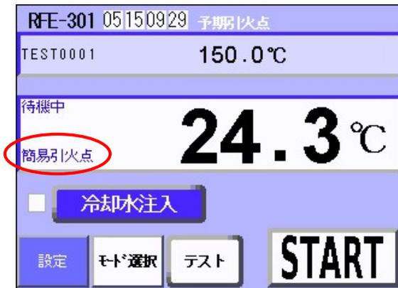
モードスイッチを押す度に、モード表示のメッセージが、“簡易引火点”→“消防法”→“一定温度保持”と順次切り替わります。
