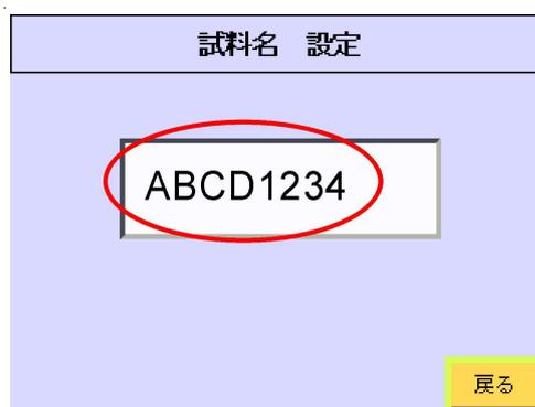
表示された試料名の部分を押すと試料名設定画面が現れ、文字入力部をクリックして現れたキーボードで試料名を入力します。
